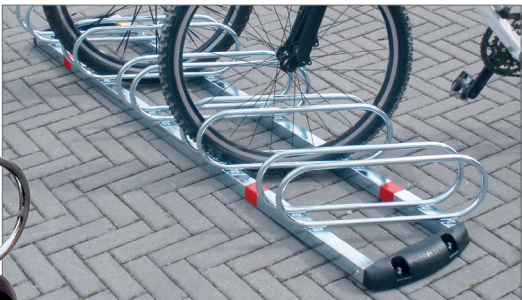
ASR500 Portabiciclette a 5 posti inclinati (60°), dimensioni 1786 x 443,8 x altezza 226 mm, peso 12 kg. Kit fissaggio incluso.
