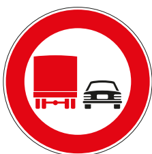
F.H. 260052 divieto di sorpasso per vei- coli > 3,5 t a pieno carico
