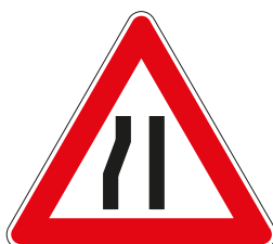
F.R. 190018 strettezza asimmetrica a sx
